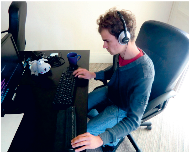
FIGURE 1 – La plage tactile et le casque transmettent les informations affichées à l'écran
