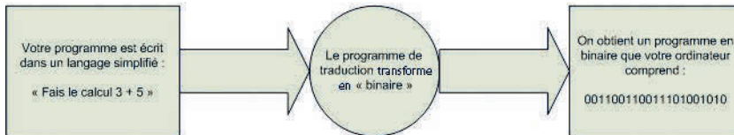
FIGURE 1.1 – Traduction d'un programme en langage binaire
